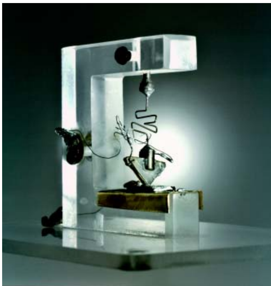
Figura 2. Primeiro transistor, construído, em 1947, por Bardeen, Brattain e Shockley
